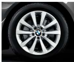
□ Jantes en alliage léger 18" (46 cm) style 328 à rayons en V avec pneumatiques RSC permettant le roulage à plat, 8 J x 18 pouces, pneumatiques 245/45 R 18.
