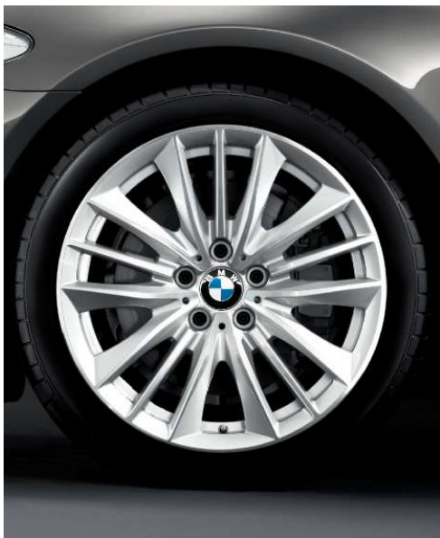
□ Jantes en alliage léger 19" (48 cm) style 332 à rayons en W avec pneumatiques RSC permettant le roulage à plat, 8,5 J x 19 pouces, pneumatiques 245/40 R 19.
