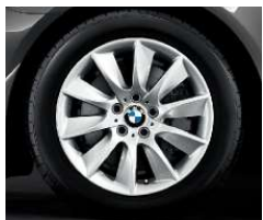
□ Jantes en alliage léger 18" (46 cm) style 329 turbine avec pneumatiques RSC permettant le roulage à plat, 8 J x 18 pouces, pneumatiques 245/45 R 18.
