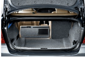
Banquette arrière rabattable en deux parties asymétriques (ici représentée avec trappe à skis optionnelle). De série sur les modèles 330 et 335.
