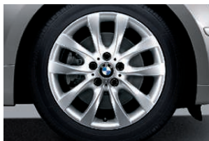
□ Jantes en alliage léger 18" (46 cm) style 217 à rayons en V avec monte pneumatique mixte RSC permettant le roulage à plat. Dimensions : 7,5 J x 18 à l'avant, pneumatiques 215/40 R 18 ; 8,5 J x 18 à l'arrière, pneumatiques 245/35 R 18.
