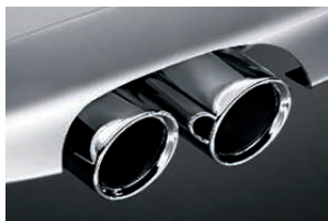
■ Double sortie d'échappement : la ligne d'échappement avec deux sorties sportives chromées est de série sur la BMW 130i.
