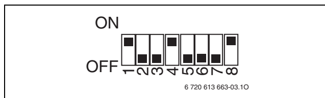
Fig. 41 Réglage d'origine pour NGLM 24-5SB (avec kit de transformation)
