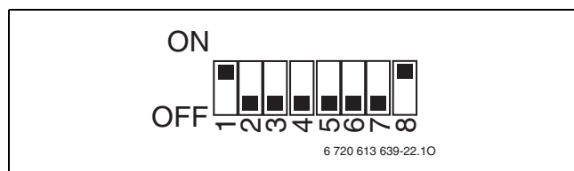
Fig. 39 Réglage d'origine pour NGVM 24-5HB, NGLM24-5HB, NGLM23-5HB5
