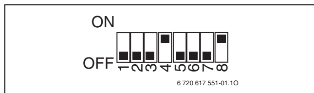
Fig. 40 Réglage d'origine pour NGLM 24-5SN (avec kit de transformation)
