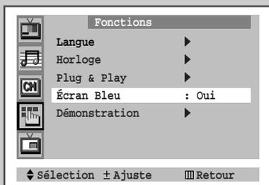
Lorsque le signal est très faible ou inexistant, un écran bleu remplace automatiquement l'image brouillée.
