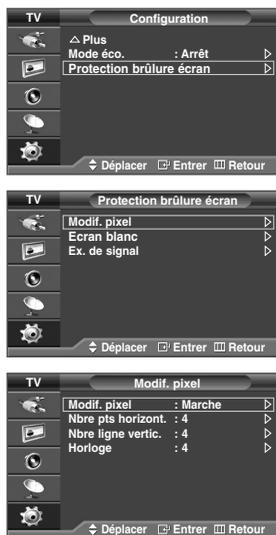
Pour réduire le risque de brûlure d'écran, cet écran est équipé d'une technologie de prévention des brûlures. Cette fonction permet de régler le mouvement de l'image de bas en haut (ligne verticale) et de gauche à droite (point horizontal). Le réglage de l'horloge permet de programmer en quelques minutes la durée séparant les mouvements de l'image.
