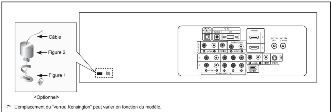
1. Insérez le dispositif de verrouillage dans la fente Kensington de la télévision LCD (Figure 1) et tournez-le dans le sens de verrouillage (Figure 2).
