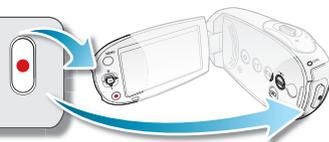
1. Ouvrez l'écran LCD et appuyez sur le bouton **Alimentation** (Ⓢ) afin de mettre le caméscope sous tension.
