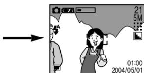
[ Enfoncez le déclencheur à mi-course et effectuez la mise au point sur le sujet ]
