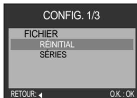
[RÉINITIAL] : Après avoir utilisé la fonction réinitialisation, le nom de fichier suivant sera paramétré à partir de 0001 même après le formatage, la suppression de l'ensemble ou l'insertion d'une nouvelle carte mémoire.
