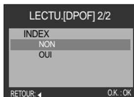
Si [NON] est sélectionné : L'image est imprimée au format d'impression standard.
