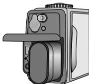
【 Insertion de la pile de type CR-V3 】
