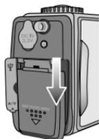
1. Ouvrez le logement des piles en faisant pression dans le sens de la flèche.
