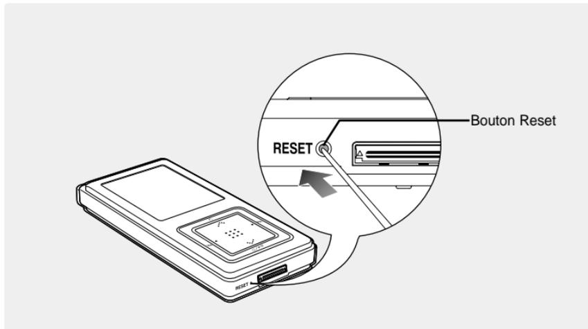
**Appuyez sur le bouton Reset situé sur la partie inférieure de l'appareil à l'aide d'un objet pointu, comme une agrafe.**
