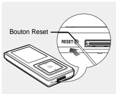
Si un dysfonctionnement de l'appareil survient, vous pouvez réinitialiser le système en appuyant sur le bouton Reset.
