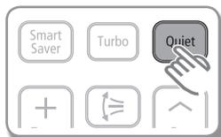
Presser le bouton **Quiet** sur la commande à distance lorsque l'unité de climatisation fonctionne en mode **Refroidissement/Chauffage**.
