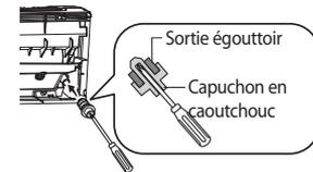
Verser l'eau dans le sens de la flèche. \* Direction de l'eau drainée
