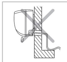
Le tuyau d'évacuation ne doit PAS être courbé.
