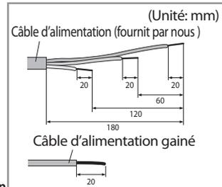
2. Insérer les deux côtés du fil conducteur du câble d'alimentation dans le manchon de raccordement (ou cosse à sertir)
