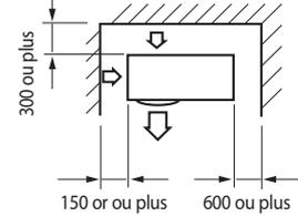
◆ La partie supérieure de l'unité extérieure et la sortie d'air est vers le mur
