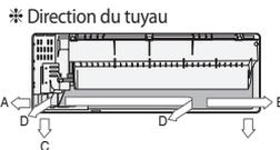
1. Déterminer la position du tuyau et le trou de tuyau d'évacuation comme on le voit dans l'image et percer le trou avec un diamètre interne de 65mm de sorte qu'il soit légèrement incliné vers le bas.
