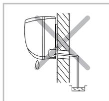
L'extrémité du tuyau de vidange ne doit PAS être placée sous l'eau.
