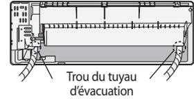
4. Faites passer le tuyau d'évacuation dans le tuyau réfrigérant, en gardant le tuyau d'évacuation étanche
