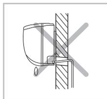
Le tuyau d'évacuation ne doit PAS se pencher vers le haut.
