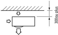
◆ Lorsque la sortie d'air est vers le mur
