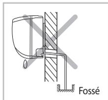
Ne placez pas l'extrémité du tuyau d'évacuation dans un creux.
