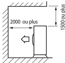
◆ La partie supérieure de l'unité extérieure et la sortie d'air est opposée au mur
