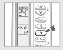
Selon la hauteur de l'unité intérieure sur le mur de la pièce, vous pouvez régler l'orientation des lames de sortie d'air au bas de l'unité, pour augmenter l'efficacité du climatiseur.
