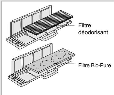
**Le climatiseur peut être accommodé avec un filtre déodorisant et Bio-Pure pour enlever les poussières et les mauvaises odeurs. Ces filtres doivent être changés tous les trois mois environ, selon l'utilisation faite du climatiseur.**
