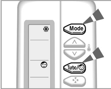
**La fonction Sleep Timer permet d'arrêter le climatiseur automatiquement après six heures de refroidissement.**
