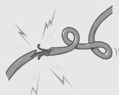
► Ne pas plier le câble électrique par force ou le climatiseur pour éviter la panne.
