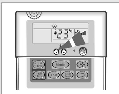
3 Pour régler la température, appuyer sur les boutons TEMPERATURE une ou plusieurs fois jusqu'à ce que la température souhaitée s'affiche.
