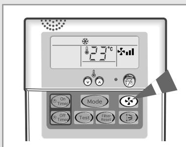
4 Sélectionner la vitesse de ventilation en appuyant sur le bouton FAN une ou plusieurs fois jusqu'à ce que la vitesse souhaitée s'affiche :
