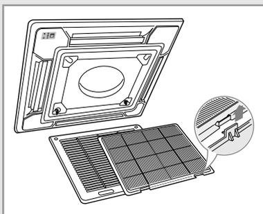
*Afin de profiter au maximum du climatiseur, il est important de le nettoyer régulièrement pour enlever la poussière accumulée dans le filtre à air.*
