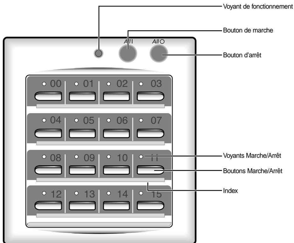
**Note** Le voyant de fonctionnement s'allume lorsqu'au moins un des climatiseurs reliés au contrôleur centralisé fonctionne.
