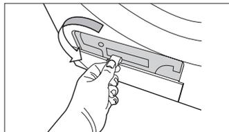
2. Déverrouillez la fixation du condensateur.
