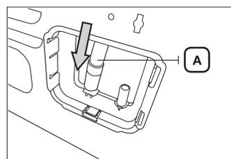
3. Raccordez le tuyau fourni (tuyau de vidange long) **B** à l'orifice situé à côté de celui raccordé au tuyau de vidange **A**.
