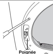
14. Placez-vous du côté droit de l'appareil et serrez les deux vis maintenant le châssis avant et les deux vis maintenant la poignée.
