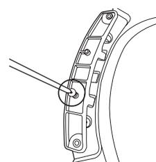
12. Retirez les deux vis maintenant le châssis avant sur la gauche.
