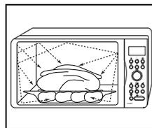
1. Les micro-ondes générées par le magnétron sont réfléchies sur les parois du four et réparties de façon homogène à l'intérieur du four pendant la cuisson grâce à une rotation du plateau sur lequel sont placés les produits. Ce procédé assure donc une cuisson homogène des aliments.
