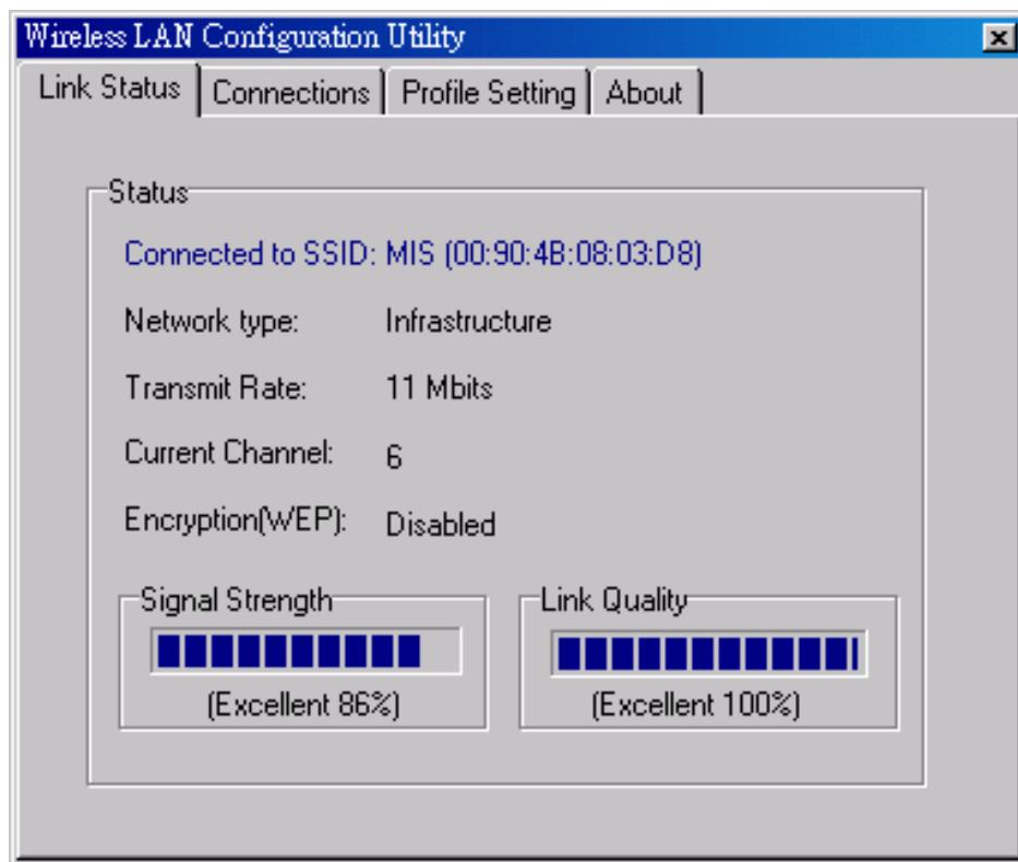
**2. Point d'Accès:** Connecte sur un réseau Ethernet sans fil via un Point d'Accès. Connectez votre Point d'Accès à la connexion du réseau Ethernet et configurez le Point d'Accès avec le “Nom de Réseau” (SSID ou ESSID) désiré. Sur le client sans fil, dans la page “Configuration” de l’Utilitaire, entrez le même “Nom de Réseau” identique à celui du Point d'Accès. Dans “Type de Réseau”, cliquez sur la flèche vers le bas, sélectionnez “Point d'Accès” et cliquez enfin sur “Appliquer”.
