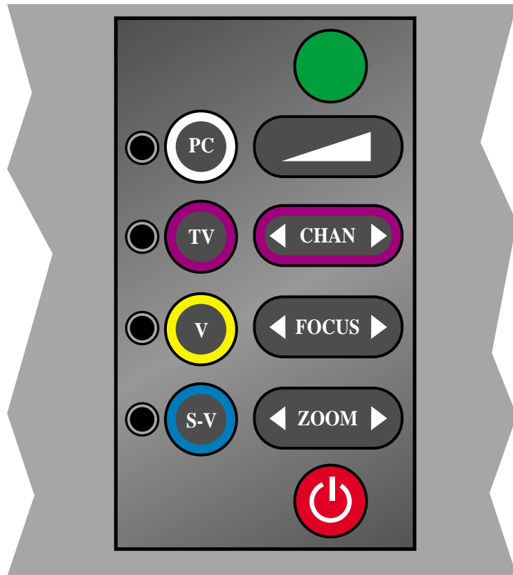
Figure 14: Touches du clavier à effleurement du projecteur
