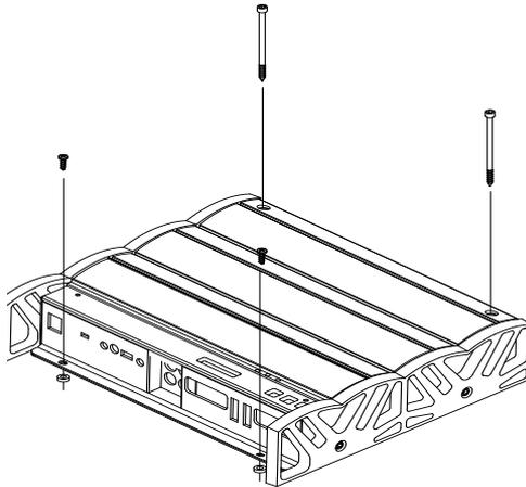
**NE PERCEZ PAS LES TROUS AVEC L'AMPLIFICATEUR EN PLACE COMME GABARIT. VOUS POURRIEZ FACILEMENT ENDOMMAGER SON ENDUIT ANODISÉ. MPLATE."**
