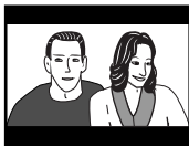
Image d'un film en DVD Écran large (16:9) sur un téléviseur 4:3 avec le réglage 4/3 Boîte lettres
