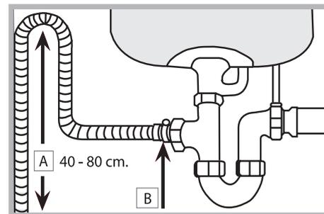
Le tuyau d'évacuation doit être placé entre 40 et 80 cm au-dessus du sol ou du plan d'appui du lave-vaisselle (A). Avant de raccorder le tuyau d'évacuation de l'eau au siphon de l'évier, retirer le bouchon en plastique (B).
