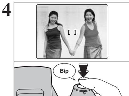
Avec le déclencheur toujours à mi-course, déplacez l'appareil photo vers l'image de départ et appuyez à fond sur le déclencheur.
