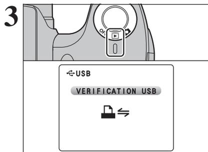
Réglez l'interrupteur d'alimentation sur "☑". Le message "VERIFICATION USB" apparaît, ensuite le menu apparaît sur l'écran.
