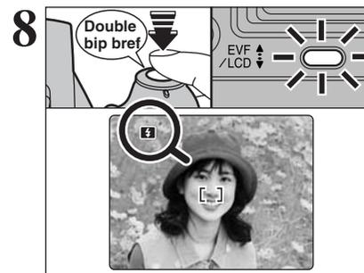
Appuyez à mi-course sur le déclencheur. L'appareil photo émet un bref double bip et effectue la mise au point sur le sujet. Le cadre AF sur l'écran devient plus petit. Le témoin de l'indicateur (vert) s'arrête de clignoter et reste allumé.
