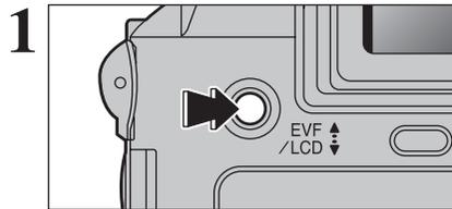
Lorsque vous utilisez le moniteur LCD pour prendre des vues, appuyez sur la touche "EVF/LCD" pour sélectionner le moniteur LCD.
