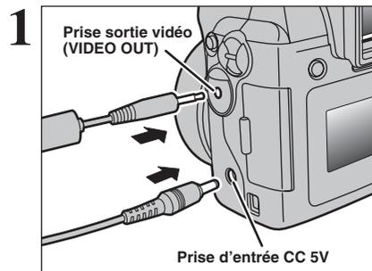
Mettez l'appareil photo et le téléviseur hors tension. Branchez le câble vidéo (fourni) dans la prise "VIDEO OUT" (sortie vidéo).
