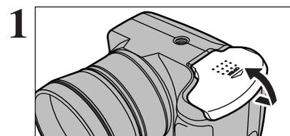
Vérifiez si l'appareil photo est hors tension (témoin de l'indicateur éteint) avant d'ouvrir le couvercle du compartiment piles.
