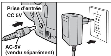
Vérifiez si l'appareil photo est hors tension. Branchez le connecteur de l'adaptateur secteur dans la prise "DC IN 5V" de l'appareil et branchez ensuite l'adaptateur secteur dans la prise murale.
