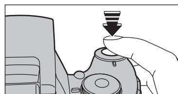
Lorsque l'appareil photo est mis en sommeil, la pression à mi-course sur le déclencheur redémarre l'appareil qui est alors prêt à prendre des photos. Ceci est utile car l'appareil photo est prêt à prendre des photos presque instantanément.
