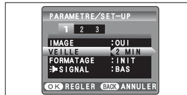
Lorsque cette fonction est activée, l'écran l'appareil photo s'éteint provisoirement et le témoin de l'indicateur (vert) clignote à des intervalles d'une seconde afin de réduire la consommation d'énergie (mode de veille) si l'appareil photo n'est pas utilisé pendant 60 secondes. Si l'appareil photo reste inutilisé pendant un intervalle supplémentaire (de 2 ou 5 minutes), il se met hors tension. Utilisez cette fonction lorsque vous désirez obtenir la durée d'utilisation maximum de votre batterie.
