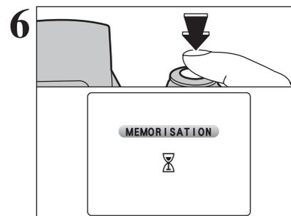
Appuyez sur le déclencheur pendant le tournage. Le tournage s'interrompt et la vidéo est enregistrée sur la carte **xD-Picture Card**.
