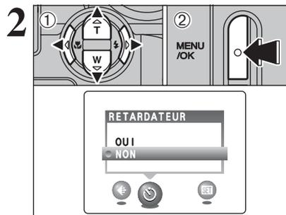
① Appuyez sur "◀" ou "▶" pour sélectionner la rubrique du menu et "▲" ou "▼" pour modifier le réglage.
