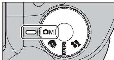
Réglez la molette de modes sur "M". Ce mode vous permet de sélectionner les réglages "Compensation d'exposition", "Balance des blancs", "Flash (Réglage de la luminosité du flash)", "Priorité ouverture" et "Détail".
