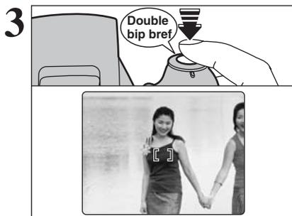
Appuyez à mi-course sur le déclencheur sans bouger l'appareil photo (verrouillage AF/AE). La mise au point est terminée lorsque le cadre AF sur l'écran se rétrécit et lorsque le témoin de l'indicateur (vert) s'arrête de clignoter et reste allumé.
