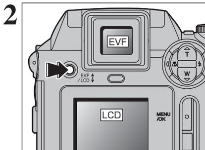
Appuyez sur la touche "EVF/LCD", l'affichage commute entre le viseur (EVF) et le moniteur (LCD). Appuyez sur la touche "EVF/LCD" pour sélectionner le viseur (EVF).
