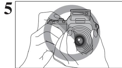
Maintenez l'appareil photo en faisant attention à ce que vos doigts ou la dragonne ne recouvrent pas l'objectif, le flash ou le détecteur de commande du flash. Si l'objectif, le flash ou le détecteur de commande du flash est obstrué, vous risquez de ne pas obtenir la luminosité (exposition) correcte pour votre photo.
