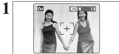
Dans une photo, les sujets (deux personnes dans ce cas) ne sont pas dans le cadre AF. Si la photo est prise à ce moment-là, les sujets ne seront pas mis au point.
