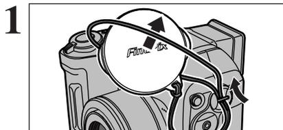
Tirez le cordon du bouchon d'objectif par la monture de la dragonne.
