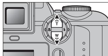
Appuyez sur "T (▲)" et "W (▼)" respectivement pour effectuer un zoom avant et arrière. Le zoom numérique peut être utilisé avec des réglages de qualité de "2M", "1M" et "0.3M". Lorsque le zoom change d'optique à numérique, l'indicateur "■" s'arrête. Appuyez de nouveau sur la même touche de zoom pour recommencer à déplacer l'indicateur "■".
