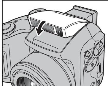
La pression sur le flash fait changer l'appareil photo en mode flash débrayé.
