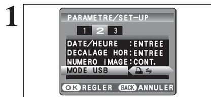
Ajustez sur "☒" dans réglage "MODE USB" dans le menu "PARAMETRE/SET-UP" (→P.60).
