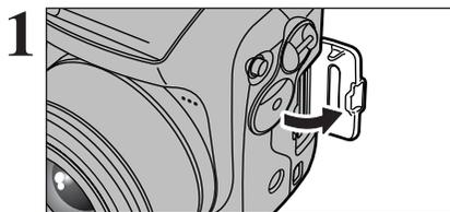
Vérifiez si l'appareil photo est hors tension (témoin de l'indicateur éteint) avant de volet de la fente d'insertion.
