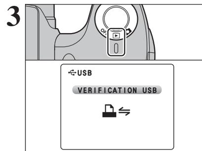
Réglez l'interrupteur d'alimentation sur "On". Le message "VERIFICATION USB" apparaît, puis l'écran du menu apparaît.
