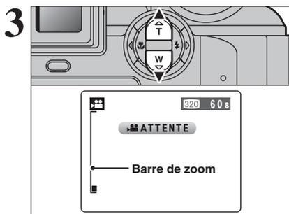
Pendant le tournage d'une vidéo, l'objectif est fixé sur le réglage de zoom en grand angle et seul le zoom numérique peut être utilisé.
