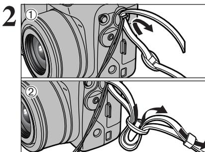
Attachez la dragonne aux montures de l'appareil photo. Lorsque vous avez fixé les deux extrémités de la dragonne, vérifiez soigneusement pour vous assurer que celle-ci est bien en place.
