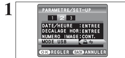
Ajustez sur "Impression" dans réglage "MODE USB" dans le menu "PARAMETRE/SET-UP" (→P.60).
