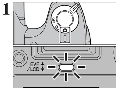
Pour mettre l'appareil photo sous tension, réglez l'interrupteur d'alimentation sur "☑" ou "▶". Lorsque vous mettez l'appareil photo sous tension, l'indicateur s'allume en vert.
