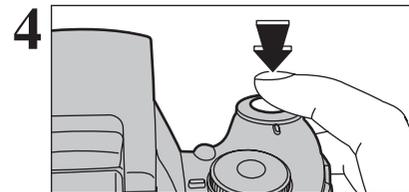
Appuyez à fond sur le déclencheur pour commencer le tournage.
