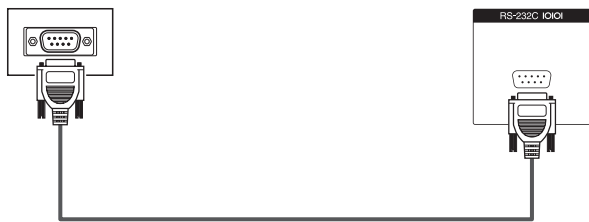
Câble série de commande RS-232C (de type croisé)
