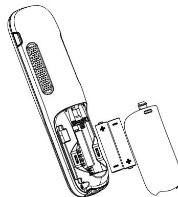
**!** Utiliser uniquement des batteries rechargeables de caractéristiques identiques à celles fournies avec le produit.
