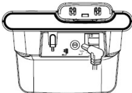
2 La batterie NiMH est déjà intégrée au combiné. Enlevez le couvercle du compartiment de la batterie en le faisant glisser vers le bas. Branchez les connecteurs de la batterie sur les prises situées à l'intérieur du compartiment de la batterie (**le câble rouge doit être à gauche**). Insérez les câbles dans l'espace situé au-dessus de la batterie puis refermez le compartiment en faisant glisser le couvercle vers le bas.
