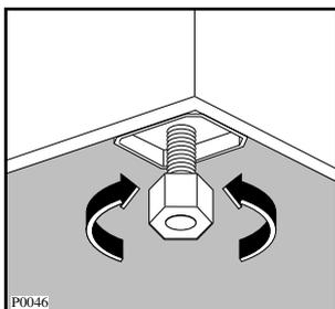
**Ne démontez pas les pieds, ne limitez pas la circulation de l'air au sol** par de tapis à longs poils, des moulures, etc. Il pourrait se produire une accumulation de chaleur qui nuirait au bon fonctionnement du moteur ou risquerait de l'endommager.
