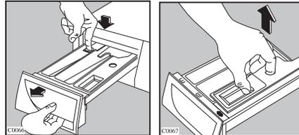
Pour faciliter le nettoyage, la partie supérieure du compartiment réservé à l'additif peut être enlevée.
