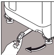
Pour déplacer votre lave-linge, il suffit de le mettre sur ses roulettes en tirant à fond de la droite vers la gauche le levier situé au bas de l'appareil. Une fois l'appareil placé à l'endroit choisi, ramenez le levier dans sa position initiale.
