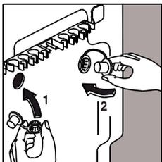
Les ouvertures désormais visibles doivent être fermées avec les caches qui sont dans la pochette jointe à l'appareil, n'oubliez pas de rabattre la capsule centrale.
