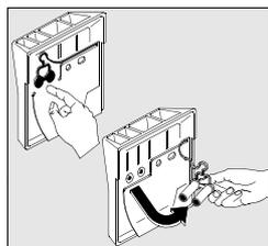
Vous pourrez ainsi la nettoyer à l'eau courante à l'aide d'une brosse ou d'un chiffon torsadé. Contrôlez que les siphons situés à l'arrière de la boîte à produits ne sont pas obstrués.
