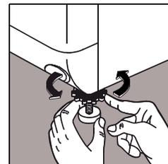
Mettez l'appareil à niveau en agissant sur le pied trop court. Dévissez ensemble le pied et la collerette (souplez l'appareil si nécessaire). Quand l'appareil est stable, bloquez le pied au sol et remontez la collerette au maximum.
