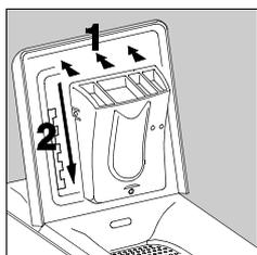
Repositionnez la boîte à produits dans les encoches jusqu'à verrouillage.
