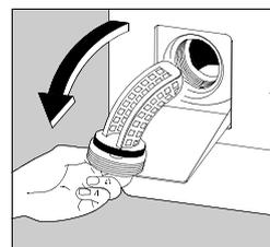
Dévissez le bouchon à fond et enlevez-le. Nettoyez-le soigneusement à l'eau courante. Replacez l'ensemble et revissez-le dans le sens des aiguilles d'une montre.
