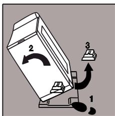
Otez l'emballage de l'appareil. Inclinez l'appareil sur le côté puis retirez la cale sous le moteur et redressez l'appareil.
