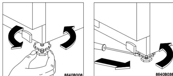
Mettez l'appareil à niveau en vissant ou en dévissant les vérins.
