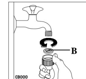
Vissez le raccord du tuyau d'alimentation sur le nez fileté du robinet d'arrivée d'eau (20x27), en ayant soin de bien positionner le joint **B** prévu dans le sachet livré avec l'appareil.
