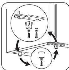
5. Enlevez la vis fixant la charnière inférieure à la porte et l'autre vis fixant la charnière inférieure de la porte et le pied de l'appareil. Retirez ensuite la charnière de la porte et le pied comme le montre l'illustration.
