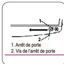
5. Faites tourner la goupille avec la tête large de la clé et retirez le cache de l'orifice gauche avec un tournevis, échangez l'emplacement de l'ensemble et fixez-le à l'aide de la méthode précédente.
