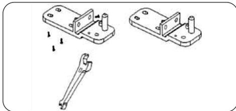
4. Retirez la butée qui se trouve sous le support inférieur de la porte avec un tournevis, puis installez-la symétriquement sur la gauche.
