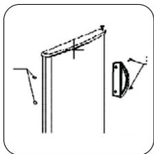
7. Installez la porte avec précautions, réglez la position de l'ensemble, déplacez la charnière vers la position symétrique à gauche, puis fixez-la avec le boulon. Utilisez ensuite le boulon pour fixer le pied réglable en position appropriée.
