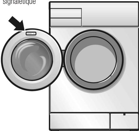
Ces indications figurent sur la plaque signalétique située sur le hublot et visible lorsque ce dernier est ouvert. Elles figurent aussi dans l'encadré épais que comporte la seconde plaque signalétique située au dos de l'appareil.
