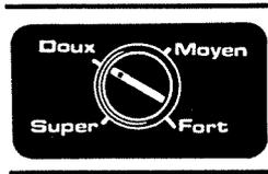
Ce bouton sert à doser la vitesse de l'essorage final. Celle-ci peut être réglée entre 360 tr/min et 750 tr/min selon les positions affichées :
