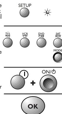
**Remarque :** lors de la programmation de la touche **AUX** ou si vous voulez affecter un autre type d'appareil que celui mentionné sur la télécommande (sauf le mode **TV1**), par exemple le code d'un Satellite sous le mode **VCR**, commencez par saisir un code correspondant à l'appareil que vous voulez programmer (code à 3 chiffres que vous trouverez dans le livret de code, voir méthode **B**). Puis lancez la Programmation rapide (comme ci-dessus).
