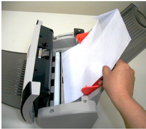
Bourrage papier dans l'ADF - Retirer le papier
