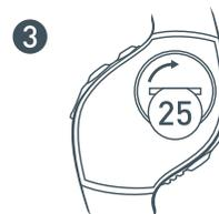
3 Remettez le couvercle du compartiment de pile en place en veillant à ne pas endommager le joint torique en caoutchouc.
