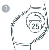
1 À l'aide d'une pièce de monnaie, dévissez le couvercle du compartiment de pile en le faisant tourner dans le sens contraire des aiguilles d'une montre.
