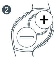
2 Remplacez la pile usagée par une pile CR2025 3 V lithium. L'écriture positive doit vous faire face. Ne touchez aucun des deux contacts.
