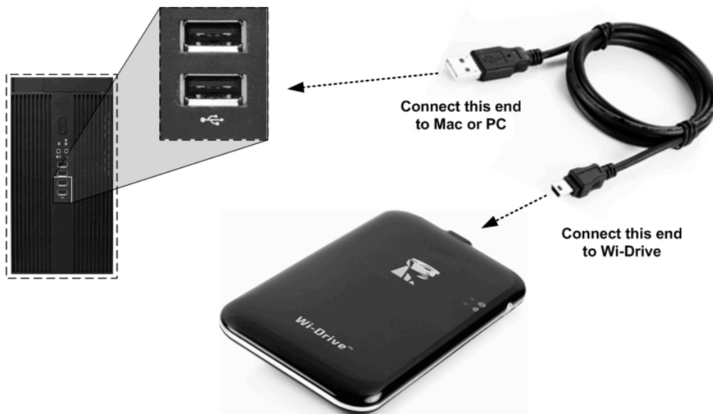
3.1. ábra – Wi-Drive csatlakoztatása számítógéphez
