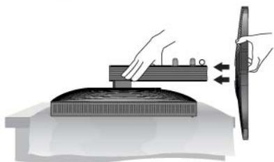
2. Posez le moniteur digital la face vers le bas sur le chiffon et installez le socle.
