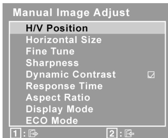
**H./V. Position (Position Horizontale/Verticale)** déplace la position de l'image à gauche ou à droite et en haut ou en bas.
