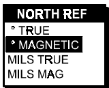
Figure D. Les options sont TRUE (nord vrai), MAGNETIC, MILS TRUE et MILS MAG.
