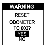
Figure A. Sélectionnez "Yes" pour remettre à zéro l'odomètre.
