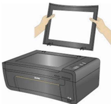
Pour le remettre en place, insérez les taquets de la charnière arrière dans les logements correspondants.
