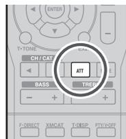
Si le signal d'entrée audio analogique sélectionné est d'un niveau supérieur à celui du traitement interne possible, l'indicateur "PEAK" s'allume sur l'écran d'affichage. Si cela se produit, appuyez sur la touche **ATT** de la télécommande.
