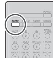
Pour mettre automatiquement le DN-A7100 en mode STANDBY, appuyez sur la touche **SLEEP** de la télécommande.
