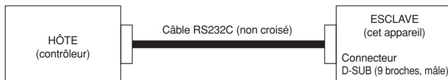
\* Le connecteur de cet appareil est de type D-SUB mâle à 9 broches.
