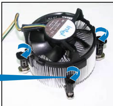
Rainure située sur une attache
