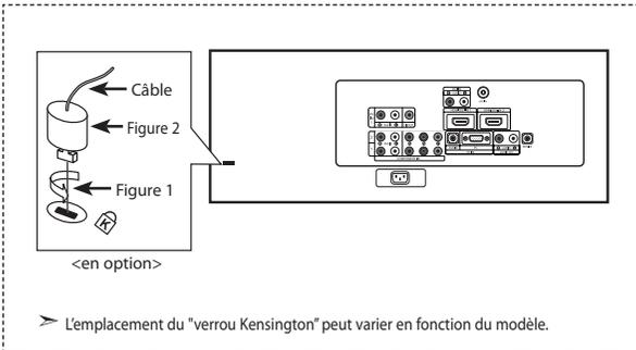
1. Kensington sur le téléviseur à écran LCD (Figure 1) et faites-le tourner dans le sens du verrouillage (Figure 2).
