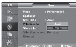
Chaque station de radiodiffusion possède ses propres conditions d'émission de signal. Il vous faut alors régler le volume à chaque fois que vous changez de chaîne. Cette fonction vous permet de régler automatiquement le volume de la chaîne désirée en réduisant la puissance sonore lorsque le signal de modulation est élevé ou en augmentant la puissance sonore lorsque le signal de modulation est faible.
