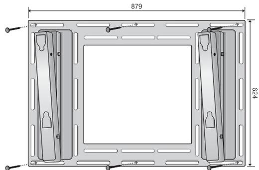
**3** En utilisant le panneau d'applique murale, vous pouvez régler l'angle d'inclinaison de l'écran plasma de 0 à 20 degrés. Il y a 5 niveaux de réglages espacés de 5 degrés chacun utilisant les orifices de contrôle de l'angle sur les côtés du panneau.
