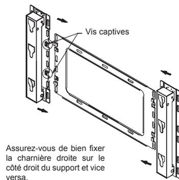
Faites bien attention aux indications de montage du support lorsque vous allez passer à un angle de 30 à 32 degrés (Les indications pour un angle de 30 à 32 degrés sont inscrites sur le support).
