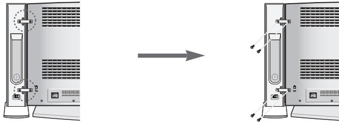
Monter les plaques de fixation sur le haut-parleur et le téléviseur/moniteur.
