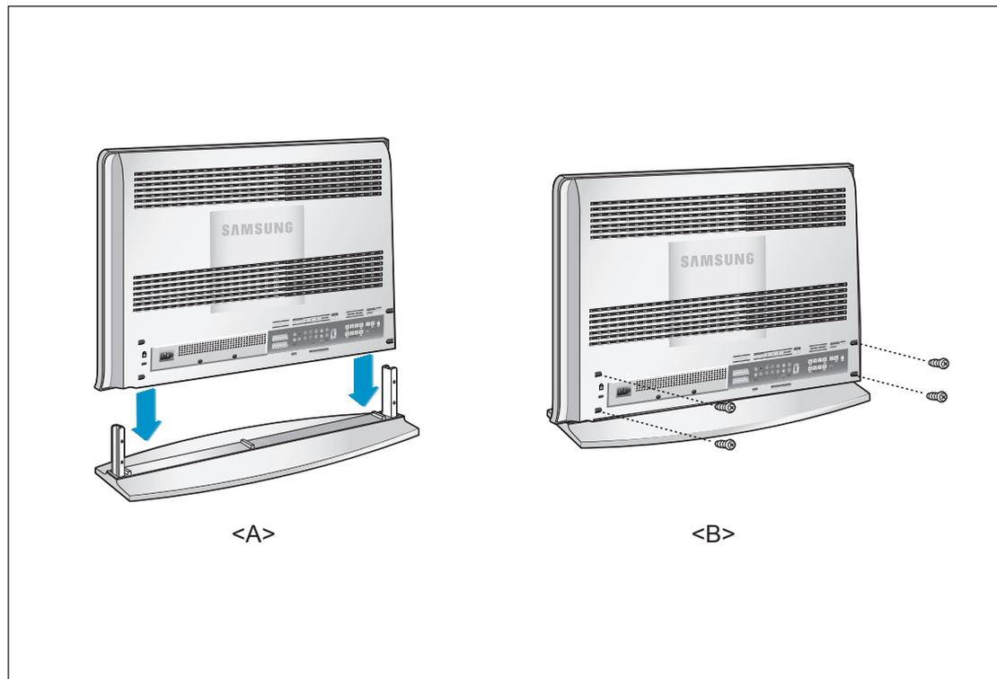
1. Abaissez le téléviseur dans la direction indiquée par la flèche (perpendiculaire au support) et fixez-le au support.
