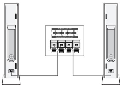
Branchez les câbles audio de l'enceinte aux prises de sortie de l'enceinte principale situées à l'arrière de votre téléviseur en vérifiant que les polarités +, - sont correctement alignées.
