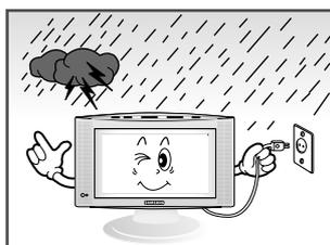
◀ En cas d'orage (particulièrement en cas d'éclairs), débranchez le téléviseur du secteur et de l'antenne.
