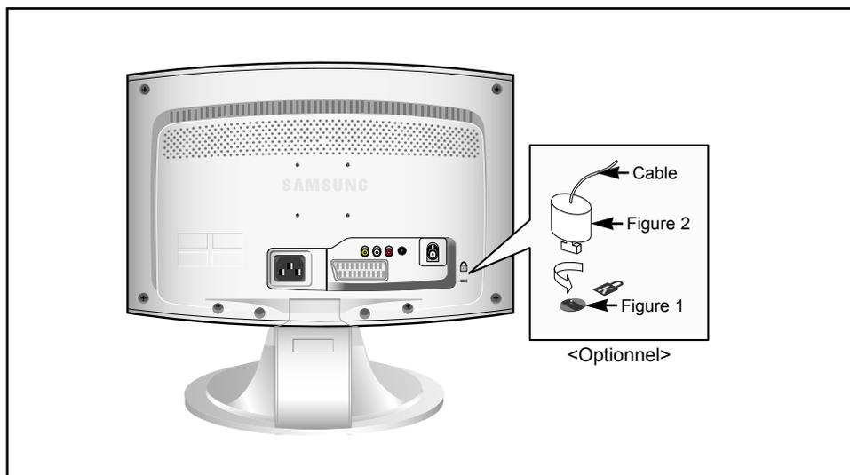
Le verrou Kensington est un dispositif permettant de fixer le système lorsqu'il est utilisé dans un lieu public. Le dispositif de verrouillage doit être acheté séparément. Il se peut que l'apparence et la méthode de verrouillage soient différents de l'illustration en fonction du fabricant. Veuillez vous reporter au manuel fourni avec le verrou Kensington pour une utilisation adéquate.
