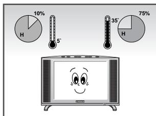
◀ N'exposez PAS le téléviseur/moniteur à des conditions de température ou d'humidité extrêmes.
