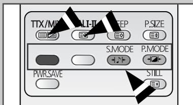
Les différents sujets inclus dans les pages télétexte disposent d'un code de couleurs et peuvent être sélectionnés en appuyant sur les boutons colorés de la télécommande.
