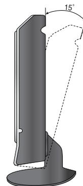
➤ Une inclinaison de plus de 15 ° pourrait provoquer une chute de l'appareil et l'endommager.
