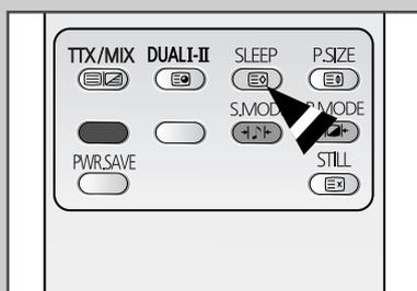
*Vous pouvez sélectionner une durée comprise entre 30 et 180 minutes à l'issue de laquelle le téléviseur LCD sans fil passe automatiquement en mode veille.*
